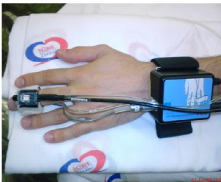
Figura 4- Colocação do sensor para geração das curvas de pressão, Finometer®
