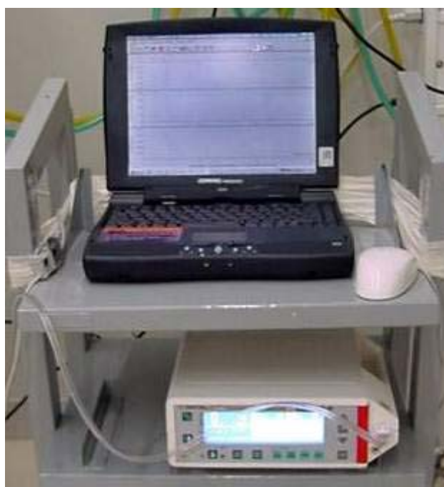
Fig. 4 – Pneumotacógrafo acoplado ao microcomputador para aquisição e armazenamento de dados.
