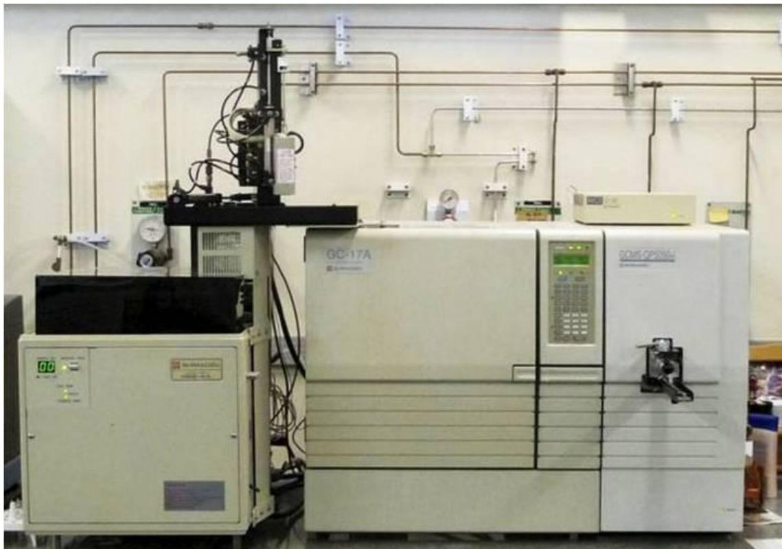
Figura 6 - Cromatógrafo a gas (GC 17A) acoplado à espectrômetro de massas (QP5050A)
