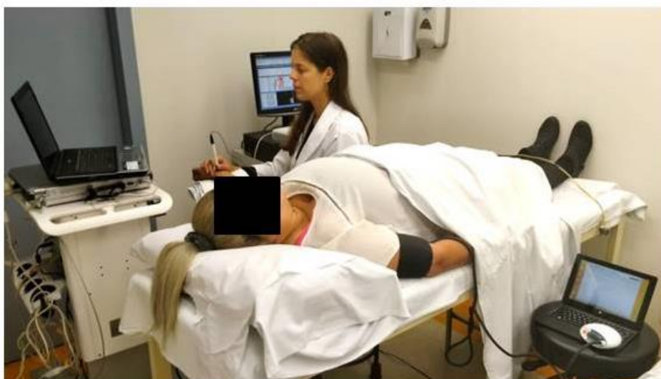
Figura 5- Realização simultânea das medidas de distensibilidade arterial pelos métodos Complior® , Arteriograph® , SphygmoCor® . Autoria própria.
