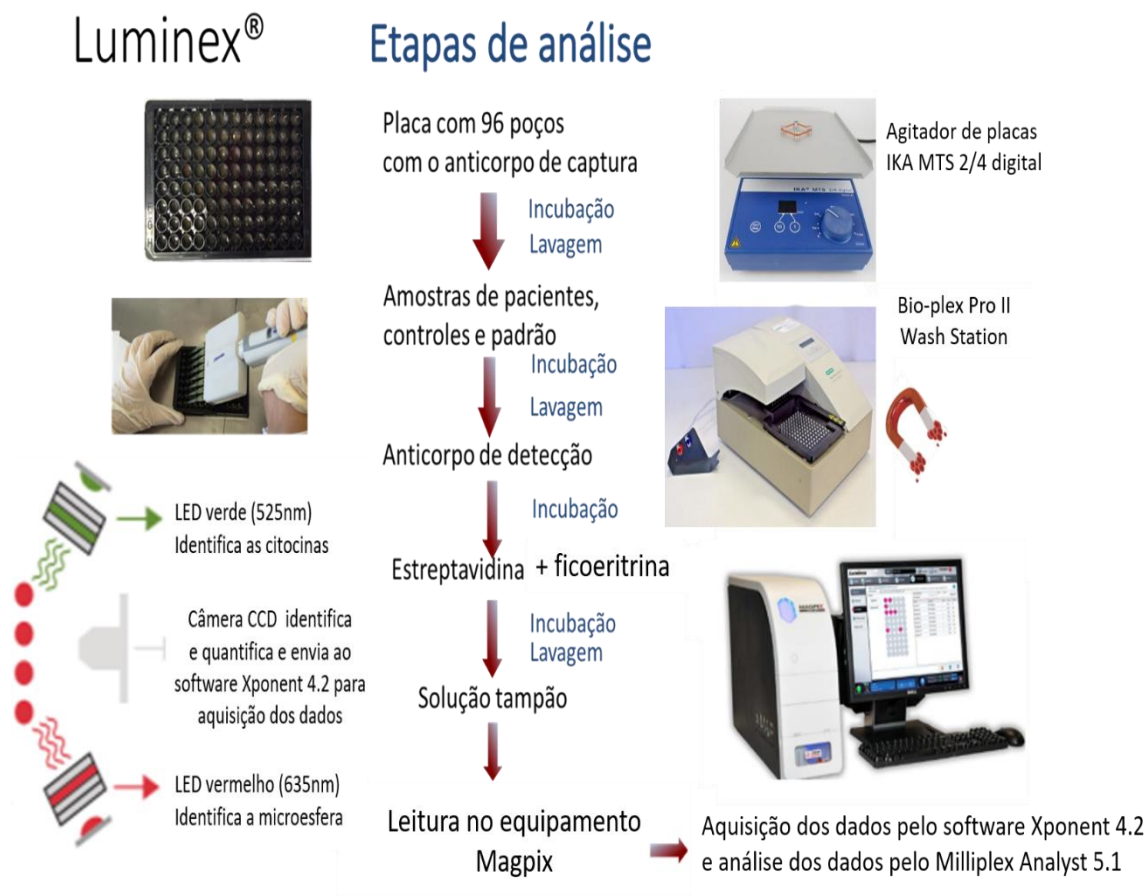
Figura 4 - Esquema ilustrativo das etapas de montagem à análise final dos dados obtidos no ensaio Luminex®
