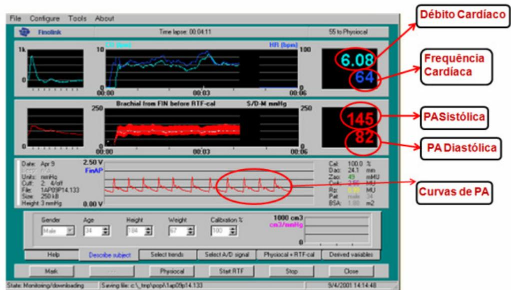
**Figura 4-** Monitor Finometer® que registra curvas de PA batimento-a-batimento, de forma não invasiva.
