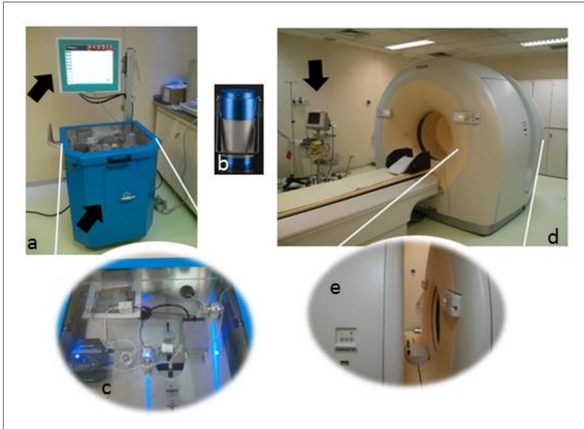
Figura 4: Equipamentos utilizados na aquisição da imagem de Rubídio-82. a) e c).Bomba de infusão do radionuclídeo; b) Gerador de Estrôncio-82; d) e e) PET/CT; setas: a) monitor da bomba e local de acoplamento do gerador; d) monitor eletrocardiográfico para GATED-PET/CT.
